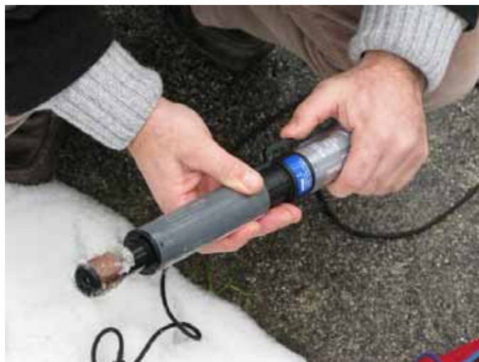
Meritve temperature vode in nasičenosti s kisikom
