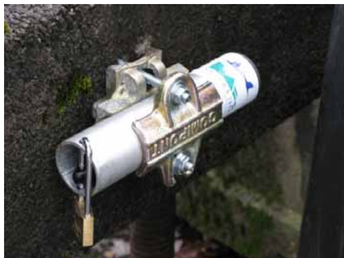
Tlačni senzor za merjenje tlaka (vodostaja) in temperature
