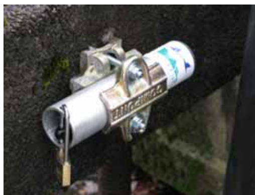
Tlačni senzor za merjenje tlaka (vodostaja) in temperature
