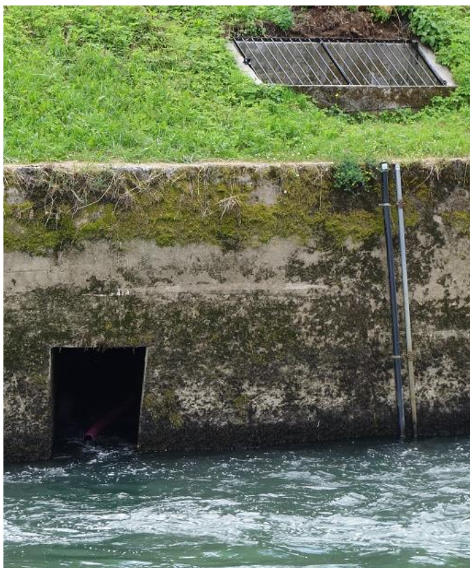
Merilca koncentracije raztopljenega kisika (levo) in vodostaja (desno) v ceveh, pritrjenih na betonsko brežino pred vhodom v ribjo stezo na Ambroževem trgu
