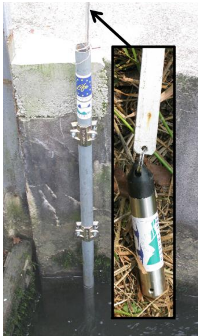
Prikaz namestitve merilca vodostaja na terenu
