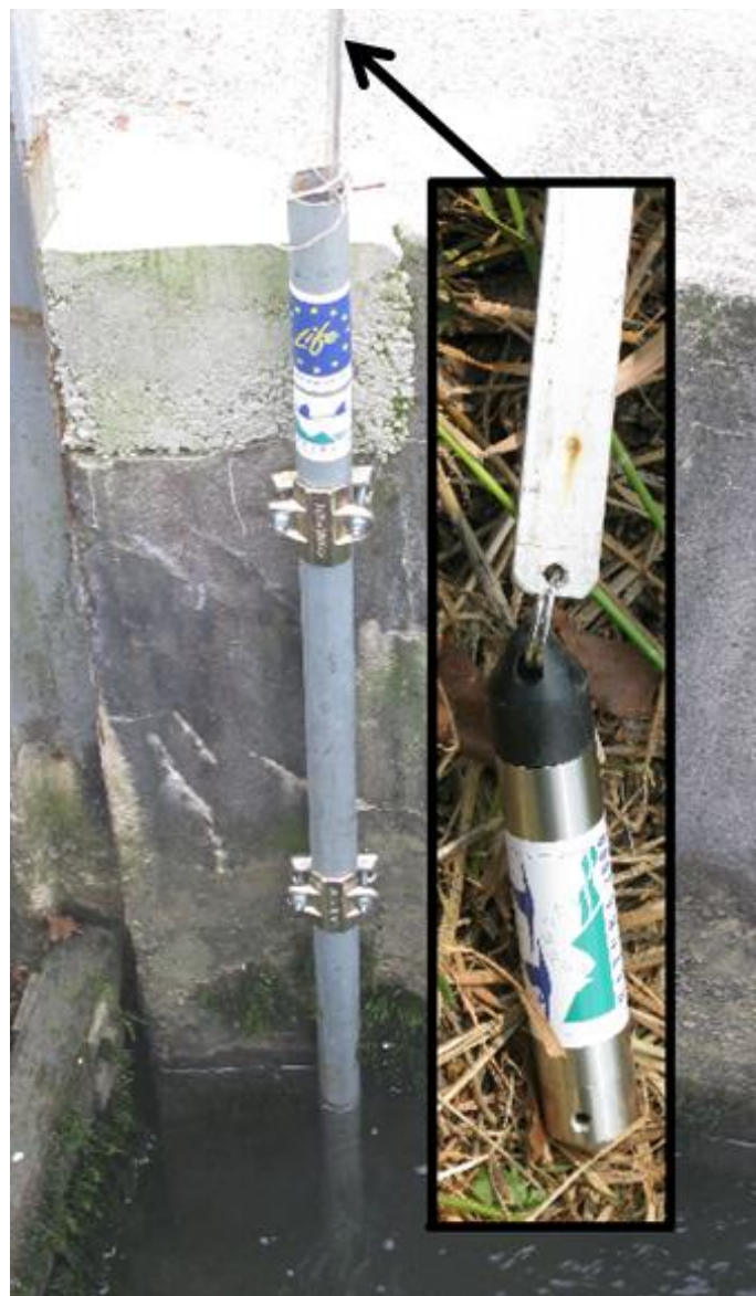
Prikaz namestitve merilca vodostaja na terenu
