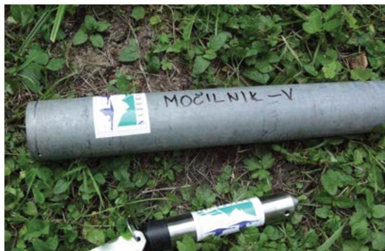
Slika 8: Merilnik vodostaja in zaščitna cev, v katero je vstavljen merilnik (foto: A. Vidmar)
