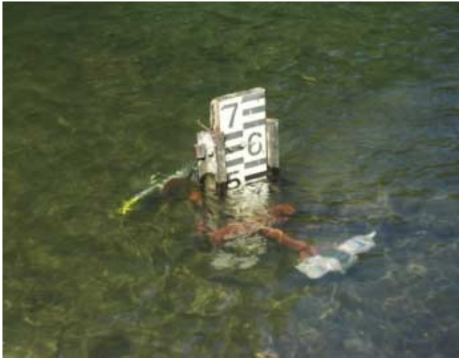
Hidrometrično krilo Valeport (levo) in ultrazvočni merilec Starflow (desno), pritrjena na mersko lato, VP Cerkvenikov mlin.
