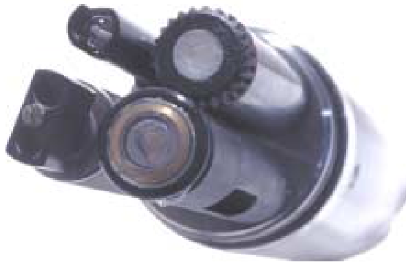
Slika 2: Glava sonde z merilnimi senzorji
